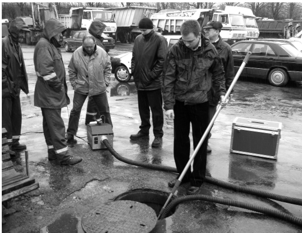
Powyżej: Pracownicy ZWiK zapoznają się z urządzeniem do kontroli przyłączy. Obok: Poletka osadowe - już nie na obecne czasy.
